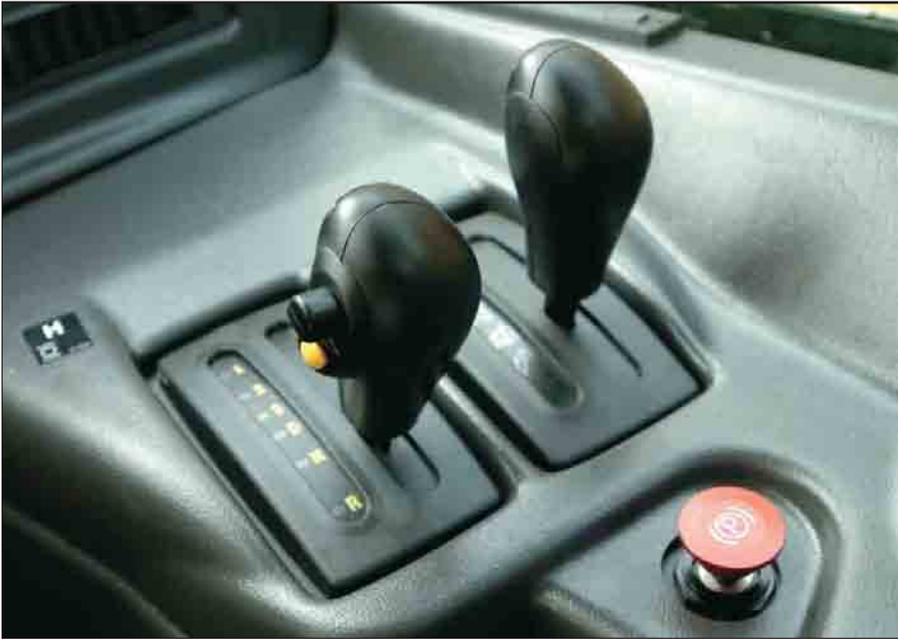
**Disegno ergonomico.** I comandi e tutta la strumentazione del 730 è realizzata con la massima ergonomia, per rendere questo dumper guidabile come una vettura. Gli strumenti di facile lettura e i comandi di facile azionamento, permettono all'operatore di concentrarsi unicamente sulla produzione.
